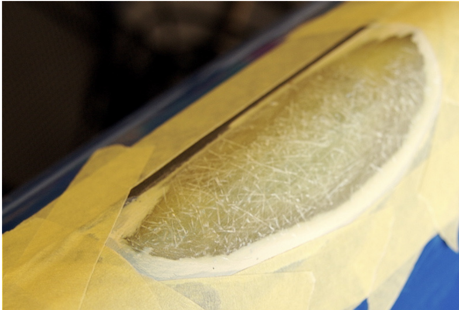
Figur 5. Her er slebet helt fint, og rensat af med acetone, så vi er helt klar til at lægge gelcoat på.
